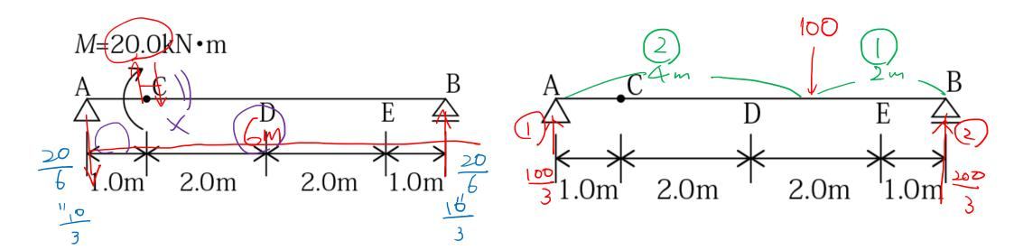
位置  $3+2\times0.3=3.6$ m/ Mmax =  $\frac{1}{2}\times(1+2.4)\times70$ =  $1.7\times70=119$   $\pm N\cdot m/$
